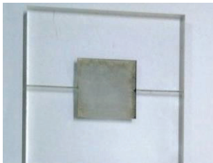
Fig. 5. 4 cmX4cm die for PDMS deposition
